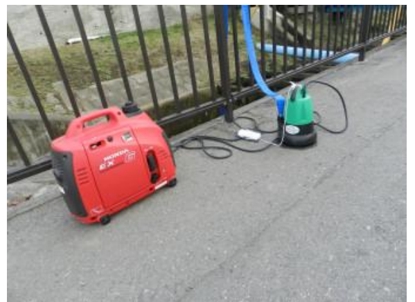
エンジン発電機を使っての水中ポンプを稼働
