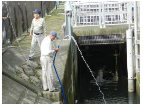
エンジン発電機を使っての水中ポンプを稼働
